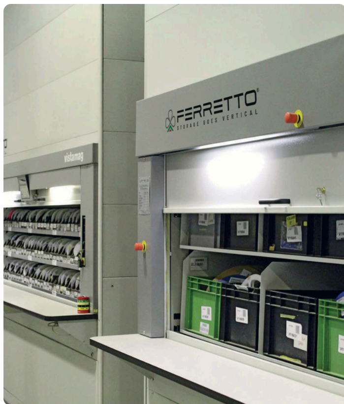
Obrotowe systemy magazynowe do przechowywania komponentów układów scalonych
